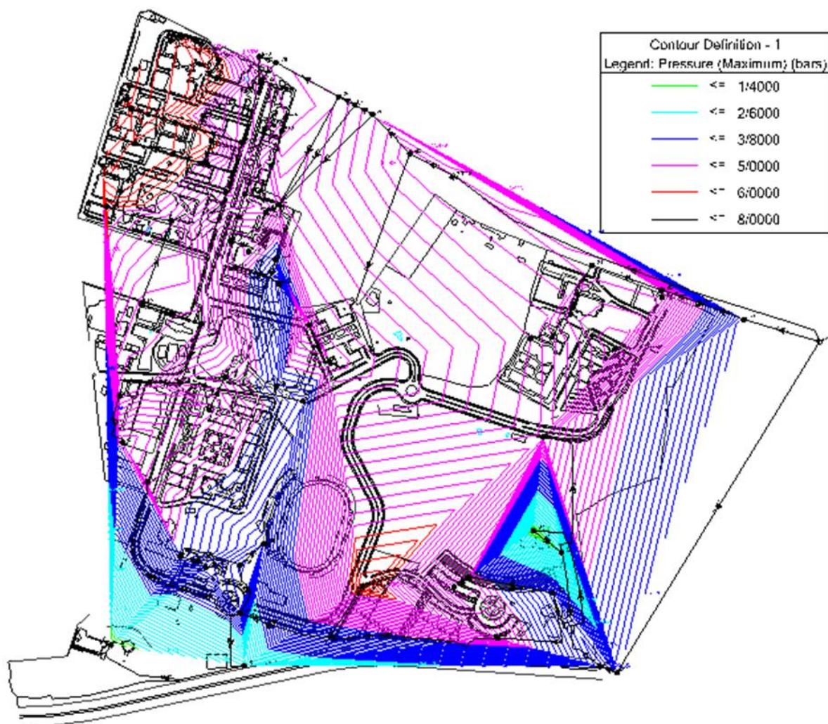
شکل ۴-۱۶- نقشه خطوط فشار در شبکه انتقال آب شرب دانشگاه تبریز در سال ۱۳۹۷ در تحلیل اولیه و حالت حداکثر تقاضا
