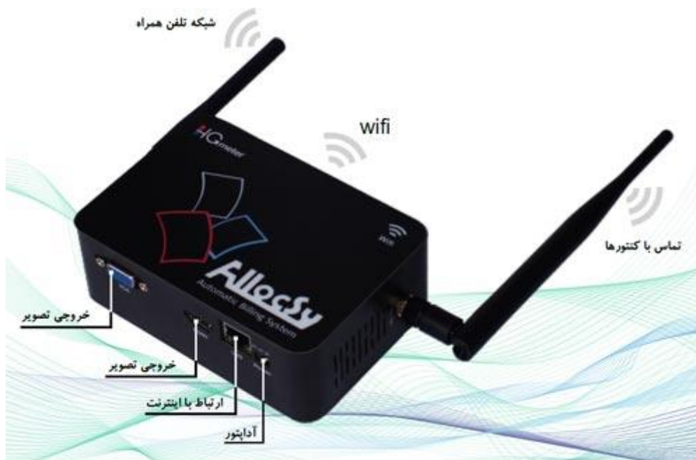
شکل ۳-۱۹- دستگاه پردازشگر مرکزی سامانه تفکیک مصرف آب
